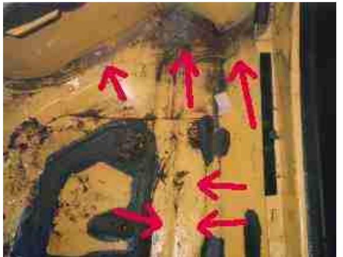
Rost am Übergang Heckblech zum Bodenblech, Seitenteil
