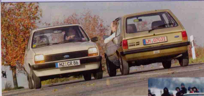
Im direkten Vergleich sind die dickeren Stoßfänger der späten Ur-Fiesta (links) gegenüber den bis 1981 produzierten Modellen gut zu erkennen
