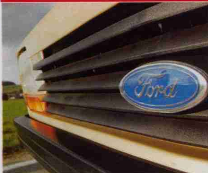
Die Lamellen des Kühlergrills trugen ihren Teil zur guten Aerodynamik des Fiesta bei
