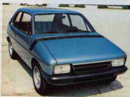
Die erste „Bobcat“-Stilstudie wurde von Ghia um die Technik eines Fiat 127 herum aufgebaut
