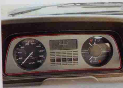
Das Kombiinstrument der Basisversion zeigte dem Fahrer/der Fahrerin deutlich, wo die Gänge lagen
